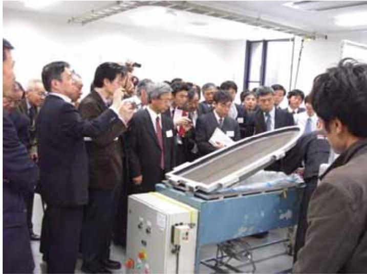
Twintex とは、Owens Corning 社によって開発された、ガラス繊維とポリプロピレン繊維を紡糸工程で直接合糸した熱可塑性成形基材であり、そのまま加熱すれば賦形できる、成形性に優る、揮発性有機化合物を排出しない、室温で保管できる、機械的性質に優る、リサイクル性、が特長である。製品の形態はロービング、ファブリック、プレート及びペレットである。写真は、Twintex ロービング（ポリプロピレン繊維と E ガラス繊維の合糸品）を織った Twintex ファブリックを用いて、船体模型を成形するデモンストレーションの状況であり、出席者の注目を集めた。成形ツールに Twintex ファブリックをセットし、ゴム製バッグを被せて吸引した後、加熱するだけで 40 分後には GFRTM 成形品ができあがった。プリプレグのバッグ成形や RTM 成形に比べると簡素にして、簡単な方法である。
